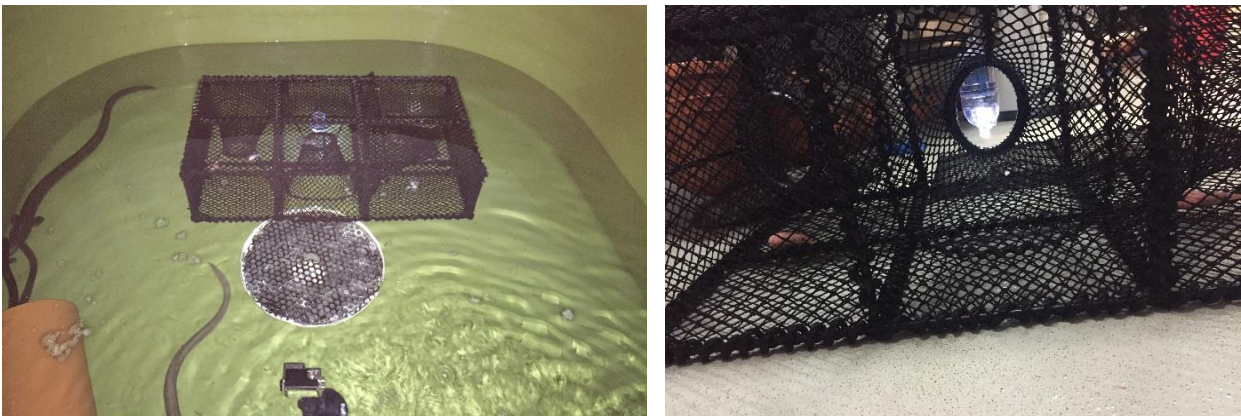
Figur 14. Effekt av lys på fangst av ål: Bildet viser forsøksoppsett med teine hvor led-lys er plassert i fangståpningen.
