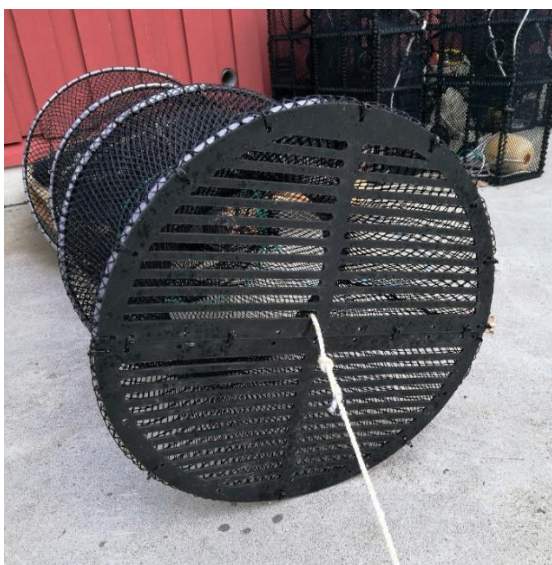
Figur 5: Ruser og seleksjonsrister brukt i kontrollerte felteksperimenter i ruse for å sammenlikne utsortering av undermåls bergnebb og grønnfylt. Her vises leppefiskruse med heldekkende enderist satt inn i siste ring. Ruseposen er vrent oppover på utsiden av rusen.
